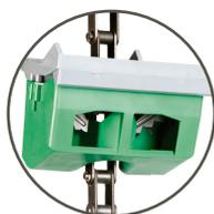
Uma das taliscas contém um balde que é a chave para a nossa calibração única. Ao jogar uma quantidade extra de grãos no sensor, uma vez por rotação da corrente, o sistema relata com precisão quando as propriedades do grão e níveis de umidade mudam.
