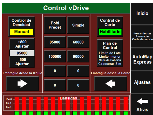
Imagen N° 32 – Sembradora en modo Manual con una única población seleccionada (Simple: 85.000 semillas/Ha)
