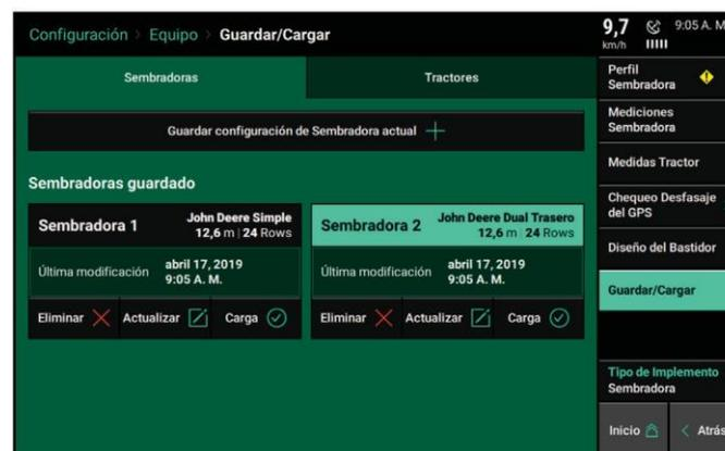
Es importante observar que cuando se cambia un Tipo de Implemento, todas las configuraciones serán reestablecidas a los valores predeterminados de fábrica. Utilizando la función Guardar/Cargar permitirá al operador en forma rápida cargar una configuración guardada previamente luego de cambiar el tipo de implemento.
