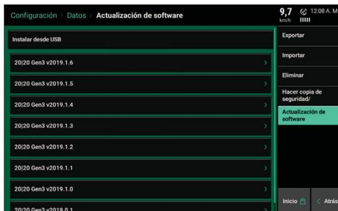
**Instalar a través de WiFi:** el software se puede descargar a través de WiFi una vez que el sistema se ha conectado a WiFi. Habrá una lista de versiones de software debajo de “Instalar desde USB” que el sistema puede descargar.
