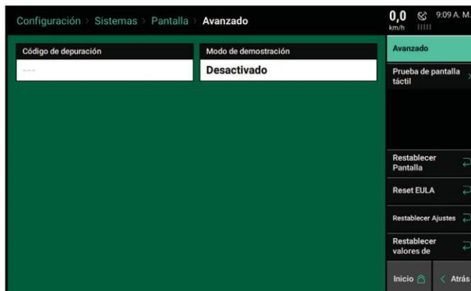
**Prueba de Pantalla Táctil** – Realizar la prueba para ver si todas las áreas de la pantalla funcionan correctamente. Al estar en la prueba, tocar la pantalla para pintar la misma de un color diferente donde fue tocada para ver si esa área de la pantalla está respondiendo al tacto correctamente. Mantener el dedo presionando en un lugar por cinco segundos para salir de la prueba.
