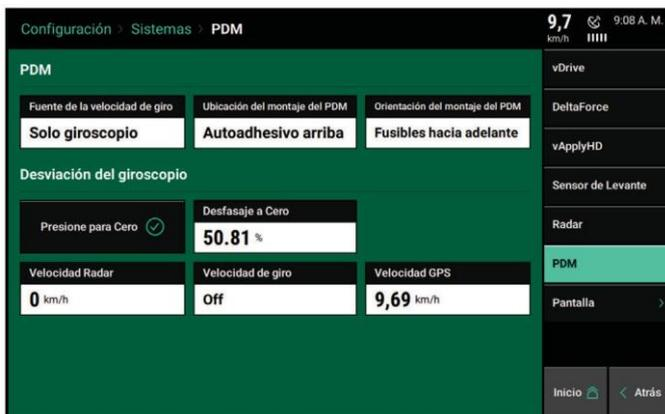
**“Presione para Cero”** – usar este botón para poner el giróscopo en cero. **Debe ser siempre puesto en cero cuando se configura un nuevo sistema.** Deberá haber un porcentaje de Desfasaje a Cero guardado luego que Giroscopio haya sido colocado en cero. Asegurarse que la sembradora esta derecha detrás del tractor cuando coloca en cero Giroscopio. Si la compensación de giro parece estar desactivada o si se obtienen advertencias sobre el giro, vuelva a poner en cero el giróscopo.
