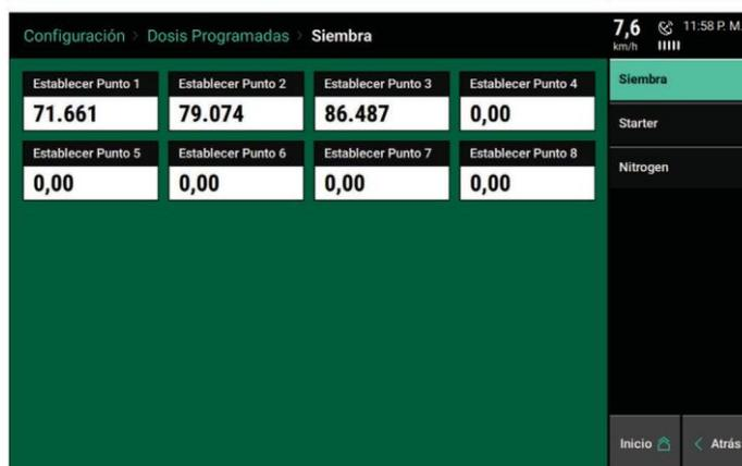
**Alarma de Flujo:** si el flujo cae por debajo del porcentaje seleccionado el botón de control de vApply se volverá rojo en la pantalla de inicio. La Alarma de Flujo puede deshabilitarse presionando el botón verde “Habilitación”, el cual se volverá amarillo y “Deshabilitado”. Seleccionar el mismo nuevamente para volver a habilitar la Alerta de Flujo.
