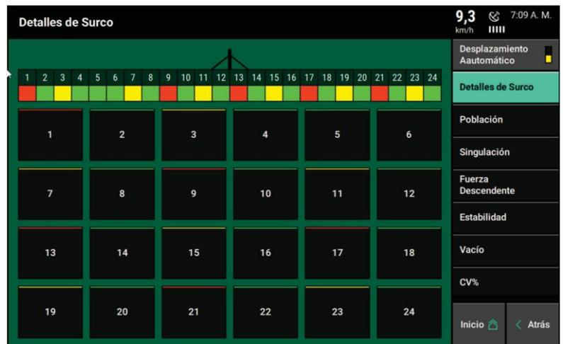
Los Detalles de Surco muestran todas las mediciones disponibles para esa fila en particular incluyendo Población, Singulación, Fallas y Dobles, Velocidad, y la visualización de semillas en vivo. Otras métricas como Fuerza Descendente o Vacío podrán no ser mostrados si el sensor apropiado no está instalado en ese surco.
