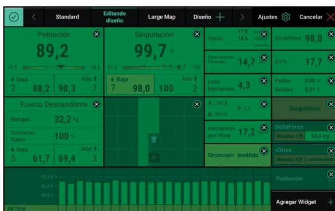
Para comenzar a editar la pantalla de inicio, seleccionar “**Agregar Widget**” en el ángulo inferior derecho. Hay cuatro tipos diferentes de “widget” que pueden agregarse a la pantalla de inicio:
