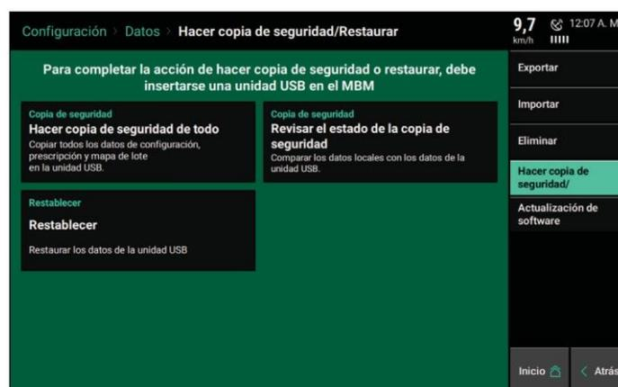
**Copia de Seguridad de Todo** – Copia todas las Configuraciones, Información y Archivos Importados de la pantalla a un dispositivo USB. Asegurarse que el dispositivo USB tiene capacidad suficiente para administrar una copia de seguridad completa. La memoria interna en el Módulo de Base de Pantalla es de 32 gig. Colocar el dispositivo USB en el puerto USB del DBM.
