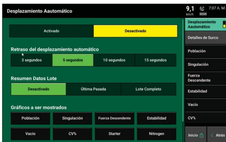
Cuando Desplazamiento Automático está **“Habilitado”**, seleccionar la velocidad a la cual el Mini Gráfico cambiará de métricas automáticamente. Finalmente, seleccionar las métricas/gráficos que serán mostrados en la pantalla de inicio
