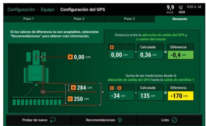
El recuadro “**Diferencia**” muestra qué tan separadas están las distancias que se ingresaron en la sembradora y las mediciones del tractor de las distancias calculadas que se realizaron durante la comprobación de desvío del GPS.
