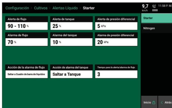
**Alerta de Flujo:** seleccionar un rango de porcentaje de flujo. Si el flujo no se encuentra dentro del rango seleccionado, el botón de control vApply en la pantalla de inicio se volverá amarillo. El Alerta de Flujo puede deshabilitarse presionando el botón verde de “habilitado”, el cual se tornará amarillo y “Deshabilitado”. Seleccionar el mismo nuevamente para volver a habilitar la Alerta de Flujo.
