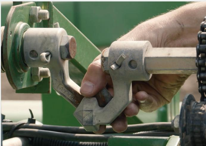
La vibración causada por componentes mecánicos como cadenas y ruedas dentadas puede hacer que un dosificador funcione correctamente y provocar que se produzcan saltos, dobles y errores de espaciado. Asegúrese de comprobar el desgaste de los siguientes componentes:
