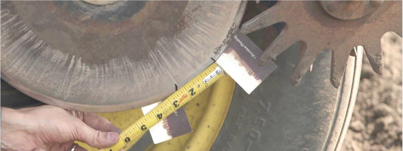
Los discos crean el surco en el que se colocan las semillas. Para asegurarse de que este proceso se realice de forma óptima, deben estar correctamente mantenidos. Los abridores que no reciben el mantenimiento provocarán rebotes y pérdida de rendimiento.
