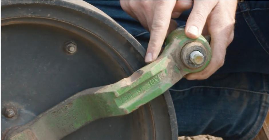
Es muy importante verificar el desgaste de los siguientes componentes del sistema de ajuste de profundidad:
