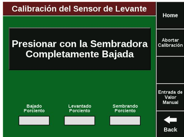
**Paso 4: Calibración del Sensor de Levante - Levantada**
