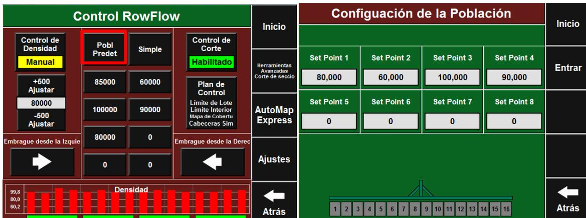
Para ajustar el valor de cambio incremental en el botón de ajuste de población a un número diferente a +/- 500, vaya a “Ajustes”, solapa “Cultivos”, presione el botón **Ajuste Rápido Población** y seleccione un nuevo valor.
