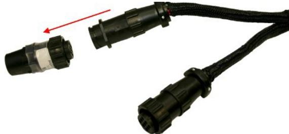
Conecte el conector hembra CAN del Arnés Base Secundario al conector macho CAN del Arnés Base primario (en el que se había quitado el CAN Terminator) y gire para asegurar la conexión. El conector macho del Arnés Base Primario debe estar conectado a la Extensión CAN de 24' (Código 727107) que llega a la cabina del tractor.
