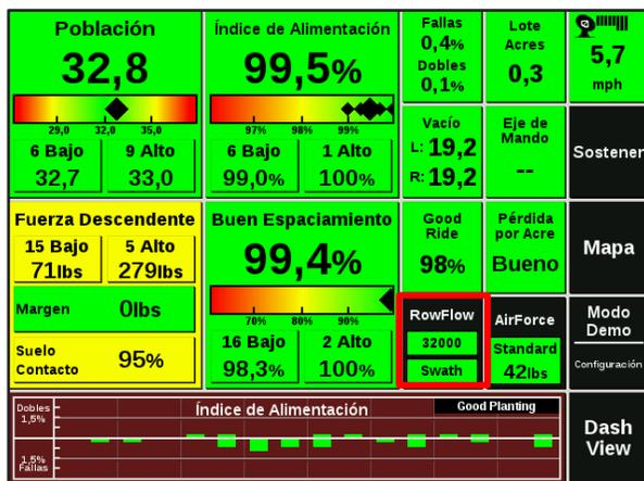
Las funciones de dosis variable de semilla y control de secciones de 20/20 RowFlow son controladas mediante el monitor 20/20 SeedSense. Cuando un módulo RowFlow es detectado, se agrega un botón RowFlow automáticamente en la pantalla principal, a la izquierda del botón Ajustes.
