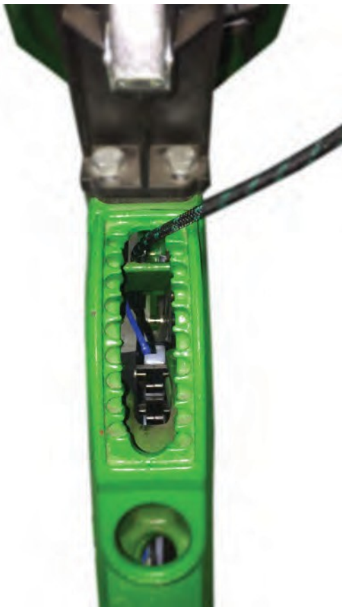
Arnés ruteado a través del sistema de control de profundidad
